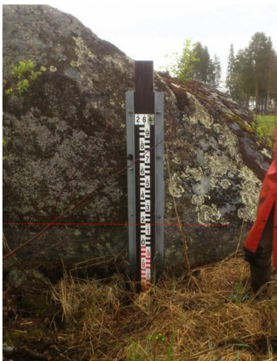
Figur 7. Lavpåväxten på block vid Lidsträsket indikerar en märkbart högre högstanivå än nuvarande dämmningsgränsen.
